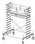
Arbeitshöhe: 4,40 m Gerüsthöhe: 3,40 m Standhöhe: 2,40 m
