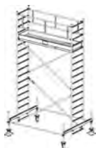
Arbeitshöhe: 5,40 m Gerüsthöhe: 4,40 m Standhöhe: 3,40 m
