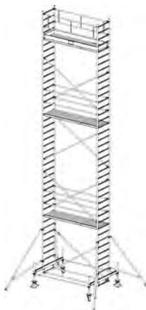
Arbeitshöhe: 11,40 m Gerüsthöhe: 10,40 m Standhöhe: 9,40 m
