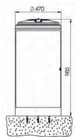
Montage auf Betonfundament
