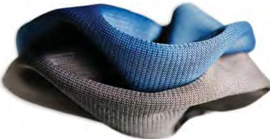
**POLYESTER** ist eine robuste, dehnbare und einlaufsichere Synthetikfaser, die aber keine Feuchtigkeit absorbiert. Es ist weit verbreitet und in vielen Varianten erhältlich. Hohe Festigkeit, gute Abriebbeständigkeit, hohe Lichtbeständigkeit.
