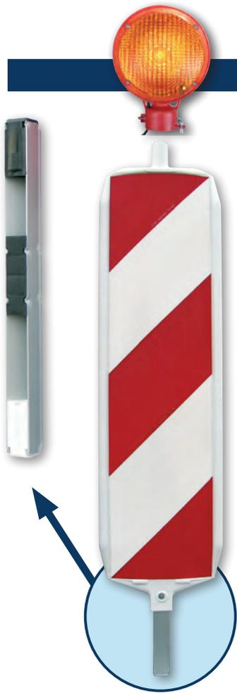
Das Bakensystem mit dem M-Adapter zeichnet sich dadurch aus, dass der Adapter an der Soll-Knickstelle umknickt, wenn die Bake angefahren wird.
