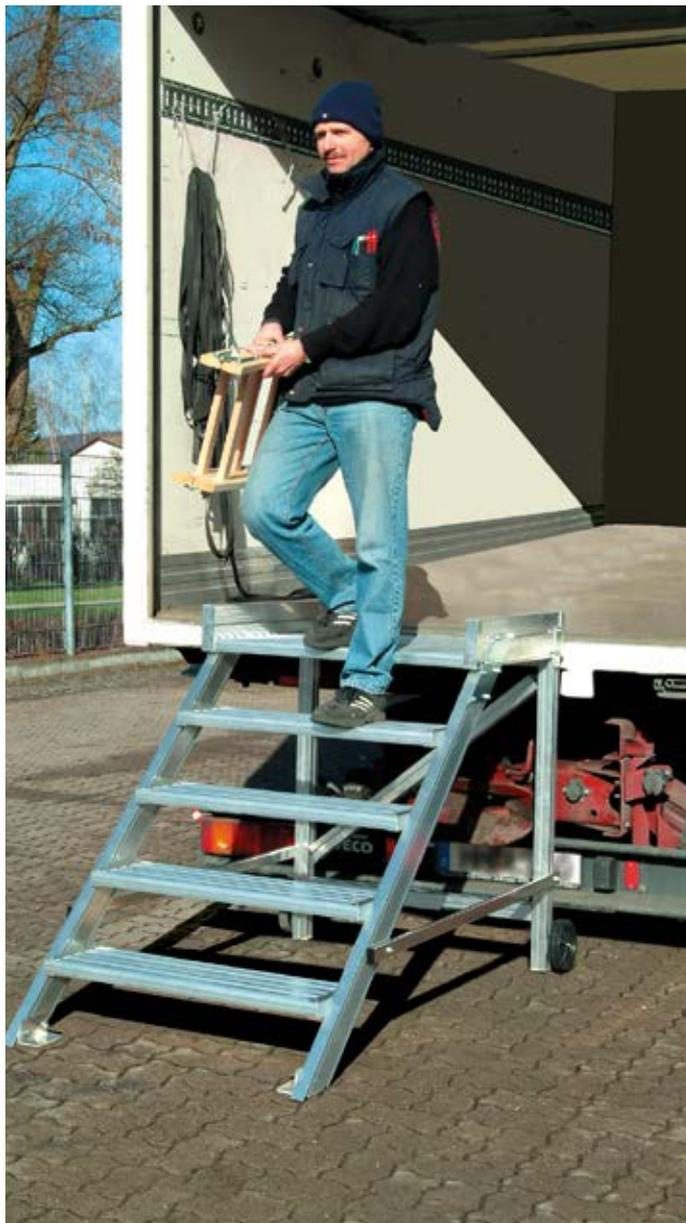
**i** Nach DIN EN ISO 14122-3 (Zugänge zu maschinellen Anlagen) ist ab 0,50 m Plattformhöhe ein Geländer erforderlich.
