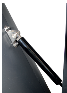
Abb.: 7705-00 Detail Gaszugfeder
