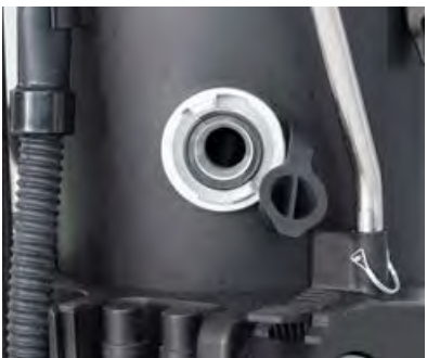
Serienmäßiger 10 Meter Schmutzwasserschlauch mit Aluminium C-Kupplung am Behälter für Feuerwehr- und THW-Schläuche.
