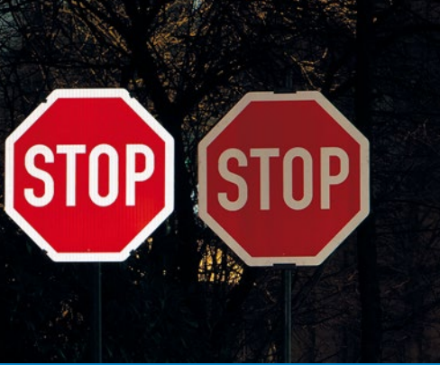
Verkehrszeichen, die ihre volle Reflexionskraft besitzen, werden schneller und früher erkannt. Dies kann unter Umständen lebensrettend wirken.
