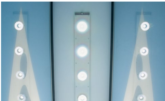
Innenleben eines innenbeleuchteten Verkehrszeichens mit LED-Technik
