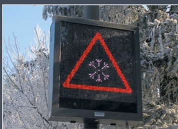
Die Glättewarnung wird beim Unterschreiten einer vorab eingestellten Temperatur automatisch angezeigt
