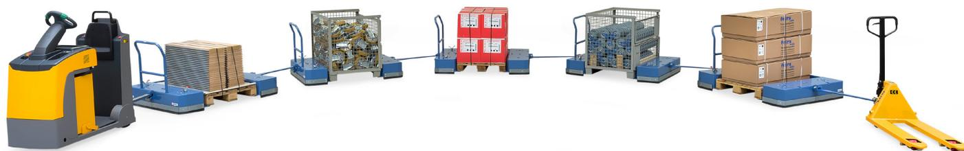
Routezug mit Elektroschlepper und 5 Niederfler-Paletten-Fahrgestellen
