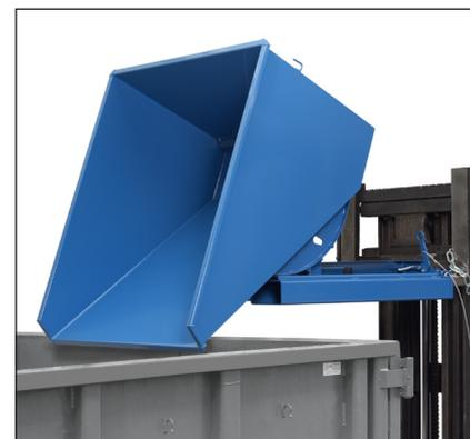
Selbstkipper als Schrottbehälter mit Gabelstapler
