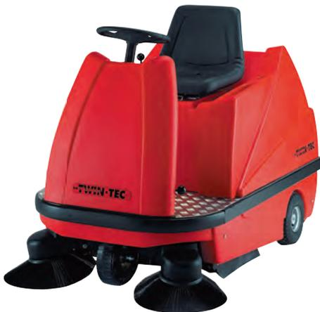
Das Kraftpaket in der Kompaktklasse mit über 4 Stunden Laufzeit mit einer Batterieladung · Alternativ Benzin oder Gasantrieb für den Dauereinsatz · Steigungen bis 20% und optionale Hochentleerung · Auch auf Teppichböden einsetzbar! Arbeitsbreite: ohne Seitenbesen 700 mm, mit 2 Seitenbesen 1100 mm · Farbe: Rot RAL 2002
