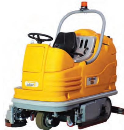
Große 36V Aufsitzmaschine mit zwei gegenrotierenden Bürsten und Wechselstromantrieb für geringen Wartungsaufwand · Regulierbarer Bürstendruck bis 160 kg · Die Arbeitsbreite beträgt 100 cm · Die Maschine bietet eine Laufzeit von bis zu 5 Stunden · Theoretische Flächenleistung: 7000m<sup>2</sup>/h
