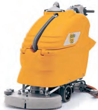
Mittelgroße batteriebetriebene Nachlaufmaschine mit zwei gegenrotierenden Bürsten und elektronischem Fahrtrieb · Bei den Arbeitsbreiten kann man zwischen 55 cm oder 66 cm wählen · Die Maschine bietet eine Laufzeit von bis zu 2,5 Stunden · Theoretische Flächenleistung: 2475/3000 m<sup>2</sup>/h
