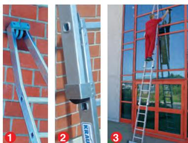
Die max. Standhöhe auf der Leiter darf nicht höher als 7,00m über der Aufstellfläche betragen (Vorgabe BGV C 22 Bauarbeiten). Der maximale Aufbau beträgt: 1+2+2+3 (= maximale Leiterlänge, siehe Abb.).
