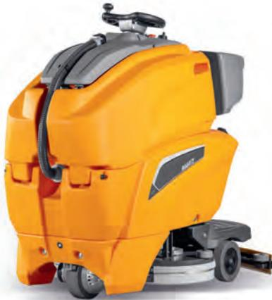
Batteriebetriebene Stand-On Maschine · Die kompakte Bauform kombiniert Komfort und Leistung mit großer Wendigkeit · Bei den Arbeitsbreiten kann man zwischen 685 mm oder 785 mm wählen · Die Maschine bietet eine Laufzeit von bis zu 4 Stunden · Theoretische Flächenleistung: 4110/4710 m<sup>2</sup>/h
