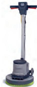
Klassische und leistungsstarke Einscheibenmaschine mit 150 U/Min. · Antriebsleistung und hoher Laufruhe · Wartungsfreies und zuverlässiges Planetengetriebe · Ideal für: Schrubben, Scheuern, Shampooieren, Schleifen etc. · Das Bürstendeck ist äußerst stabil durch die Structofoam-Bauweise · Abmessungen: 1.185 x 580 x 450 mm
