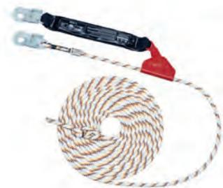
Gepr. n. DIN-EN 353-2 Mitlaufende Auffanggeräte werden vornehmlich im Steigbereich eingesetzt, damit der Anwender beide Arme frei hat um z. B. Material zu transportieren. Anwendung finden diese Geräte auch, wenn der Anschlagpunkt weiter vom Arbeitsplatz des Benutzers entfernt ist, und Bandfalldämpfer-Verbindungsstück nicht zum Einsatz kommen können. Die Geräte werden nur mit konfektionierten Seil geliefert.
