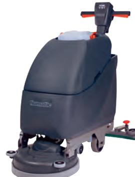
Die Scheuersaugmaschine TGB4045 ist optimal für die wirtschaftliche Unterhaltsreinigung von kleinen bis mittleren Flächen und für die Sonderreinigung geeignet · Die wartungsfreien, serienmäßigen 100 Ah-Gel-Batterien mit integriertem Ladegerät gewährleisten eine Laufzeit von ca. 2,25 Stunden · Die Maschine ist mit einem kippbaren Bürstenkopf zum einfachen Wechsel der Bürste/Pad-Loc-Treibteller und einer ergonomischen Deichselhöhenverstellung ausgestattet.
