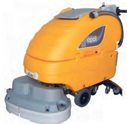
Kompakte batteriebetriebene Nachlaufmaschine mit großem Tankvolumen, zwei gegenrotierenden Bürsten und elektronischem Fahrtrieb · Bei den Arbeitsbreiten kann man zwischen 66 cm oder 80 cm wählen · Die Maschine bietet eine Laufzeit von bis zu 4 Stunden · Theoretische Flächenleistung: 2740/3140 m<sup>2</sup>/h
