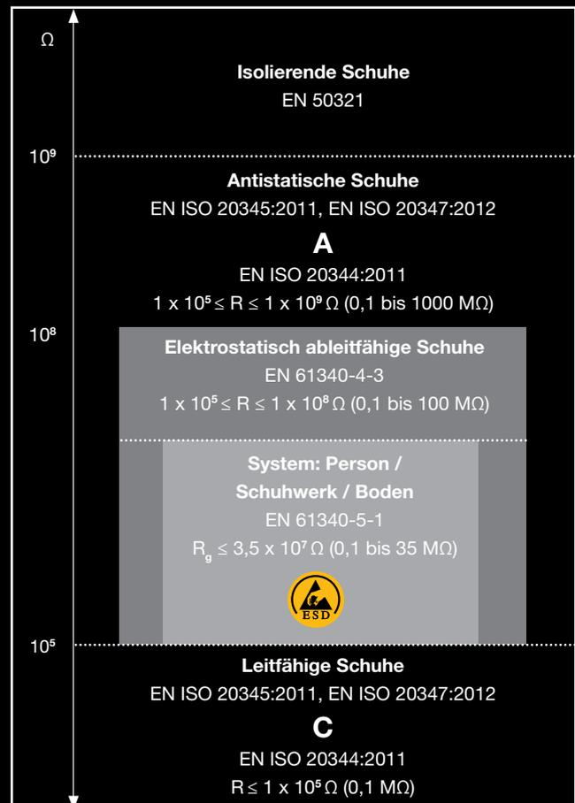
A und C: Zusatzanforderungen elektrischer Eigenschaften bei Berufs- und Sicherheitsschuhen. R: elektrischer Widerstand.  $R_g$ : Erdableitwiderstand.
