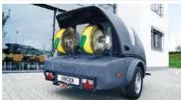
Geeignet für Fahrzeuge mit Anhängelast von bis zu 1.500 kg. Tank mit hoher Kapazität, integriert in Leichtbau-Chassis für sicheres Manövrieren. TÜV-zugelassen, einachsig, integrierte Bremse, Beleuchtung und Blinker. Lieferung mit europäischer Standardkuppelung, Stützrad und Handbremse sowie Standfuß zur Standsicherheit. Mit EU-Konformität.
