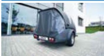
Optionale Abdeckplane zum Schutz der Schlauchrollen. Stabile Lkw-Plane, kann an Ösen und Befestigungspunkten des Rahmens fixiert werden.
