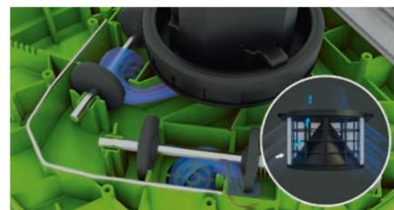
Filterreinigung durch Umkehrung des Luftstroms
